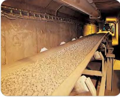
運搬物の温度が60℃以上の場合には耐熱性コンベヤベルトを使用することをお勧めします。カバーゴム損傷の程度は運搬物の温度、形状によって異なるため、使用条件に適合した材質選択が何より大事です。特に注意すべきことは、運搬物の温度とベルト表面温度との関係です。これは運搬物の形状、ベルト長さ、ベルト速度、使用場所の環境及び移動時間などによっても異なりますが、主に運搬物についてベルト表面への熱伝導の程度が違い、リターン側から冷却が行われるためです。
