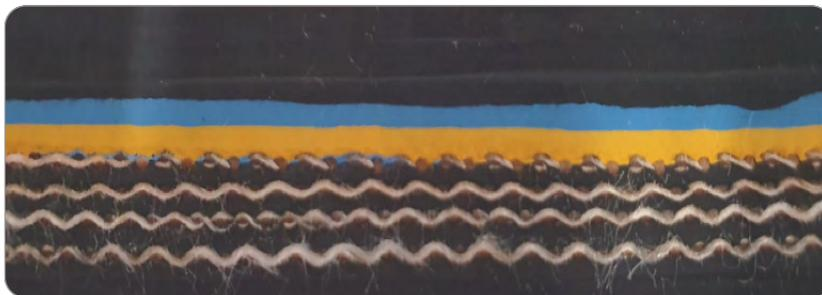
バケットエレベーター コンベヤベルトはベルトの全体の長さ方向に沿ってバケットを取り付けるボルトの穴があるため破れやすく、バケットの重さにより引っ張る力が加えられ、プーリには曲がる時の引発力など、普通のベルトとは違う作用を受けます。したがって芯体にはこのような問題点を補完可能な特性のあるポリエステルが主に使われ、高強度ベルトが必要な場合にはスチールコードを適用します。
